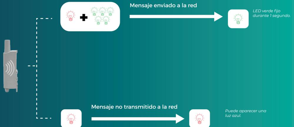
Los indicadores luminosos son visibles en la parte inferior del repetidor y solo aparecen cuando este repite o emite.
