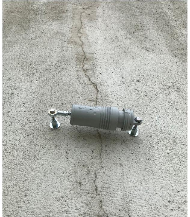
Dans le cadre de l'observation de l'évolution des désordres constatés sur un silo à grain en béton, un de nos client **Coopérative Agricole Céréalière** a décidé d'instrumenter l'ouvrage. La stratégie adoptée consiste à **installer des capteurs de fissures DELTA L+ pour suivre l'évolution des fissures en paroi et d'une lézarde au niveau dallage.**
