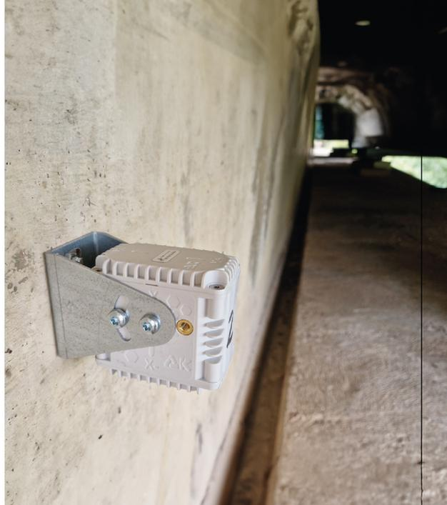
La stratégie adoptée par la **DIR** est de déployer des capteurs **DELTA R** afin de disposer d'une surveillance régulière et active des culées du pont, l'ouvrage restant ouvert à la circulation et aux usagers.
