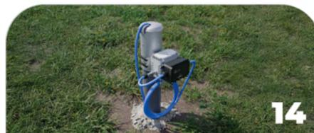
Chiudere il coperchio per evitare qualsiasi ostruzione del tubo piezometrico, quindi collegare all'app mobile per impostare il sensore.
