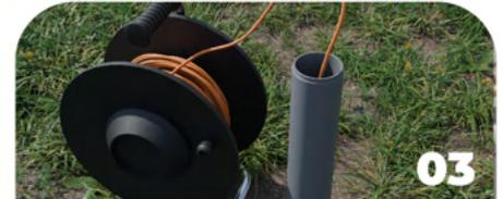
Effettuare una prima misurazione(1) per determinare il grado attuale della tabella. Questa misurazione deve essere effettuata con una sonda piezometrica manuale.
