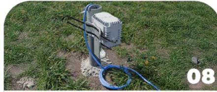
Per fissare l'intero sistema al tubo, utilizzare i collari Rilsan. Inserirli nelle fessure previste, posizionare il sistema attorno al tubo e stringerlo saldamente (senza danneggiare il tubo o l'apparecchiatura).
