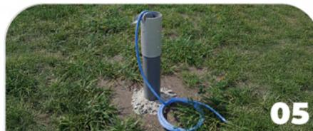
Quindi, collocare una parte del coperchio di chiusura e inserire delicatamente la sonda in acciaio inossidabile nel tubo piezometrico.
