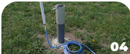
Preparare l'apparecchiatura e srotolare il cavo, la sonda e l'alloggiamento Patm con attenzione per evitare danni ai componenti del sensore.
