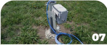
Fissare il Delta X avvitandolo alla staffa di montaggio, assicurandosi che sia in piano.
