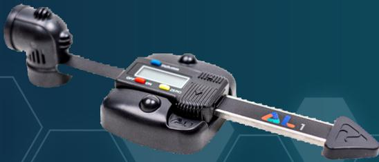
**Il DELTA L è ideale per un preciso monitoraggio manuale delle fessure su tutti e tre gli assi di misura - apertura, taglio e svasatura ma anche misurazione dell'angolo.**
