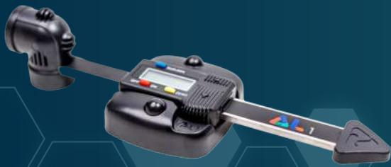
**Le DELTA L est idéal pour le suivi manuel précis des fissures sur les trois axes de mesure - ouverture, cisaillement et désaffleurement mais aussi la mesure d'angle.**
