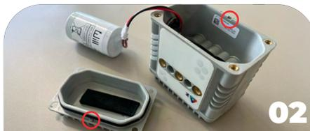
Ajoutez de la graisse pour graisser le joint puis remplacez le couvercle du DELTA X et prenez soin de bien vérifier que le joint torique est bien positionné pour refermer le couvercle correctement.
