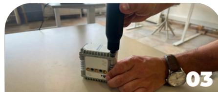
Serrez les vis uniquement à la force des doigts jusqu'à ce que le rebord du couvercle soit visiblement plaqué au corps du capteur.
