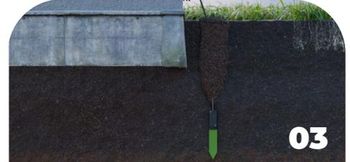
Exemple de photo de sonde delta XH, entrain d'être enfoncée dans le sol.
