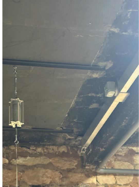
Un extensomètre a été installé entre le sol et le plancher afin de mesurer les variations de convergence et de détecter un éventuel affaissement lié à la machine. En complément, une ligne inclinométrique a été mise en place pour suivre avec précision les déformations des éléments porteurs, en particulier de la poutre centrale.
