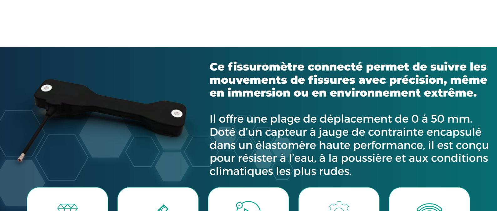
**Ce fissuromètre connecté permet de suivre les mouvements de fissures avec précision, même en immersion ou en environnement extrême.**
