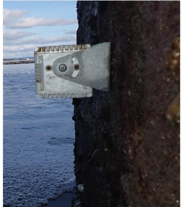
**Le Moulin de Pencastel, classé monument historique, a récemment fait face à des défis structurels, notamment des fissures préoccupantes et des vides potentiels dans la maçonnerie.** Un bureau d'études a décidé d'instrumenter l'ouvrage avec notre fissuromètre Delta L Max et notre capteur connecté de mouvement d'inclinaison, le Delta R, dans l'objectif d'assurer la préservation de ce patrimoine sans engager immédiatement de travaux coûteux.
