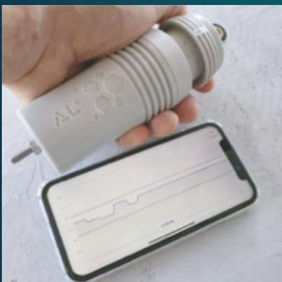
Une fois connecté en bluetooth, vous pouvez sélectionner le mode assistance pose capteur ce qui vous permet de suivre en temps réel les mouvements d'ouverture et fermeture enregistré par le capteur et de prendre en main votre capteur
