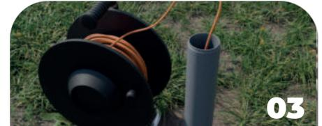
Effectuez une première mesure<sup>(1)</sup> pour relever la cote actuelle du niveau de la nappe. Cette mesure doit être réalisée à l'aide d'une sonde piézométrique manuelle.
