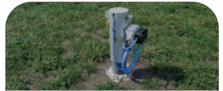
Refermez le capot pour éviter toute obstruction du tube piézométrique, mettez un cadenas pour plus de sécurité puis connectez vous à l'application mobile pour paramétrer le capteur.
