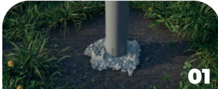
Localisez le tube piézométrique de votre zone pour l'installation de la sonde et l'installation du boîtier.
